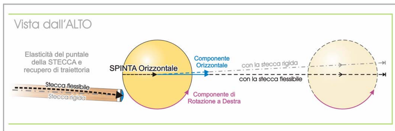
Fig. 3.1: Recupero della traiettoria per l'elasticità della stecca, quando non si colpisce la biglia nel suo centro di massa.
